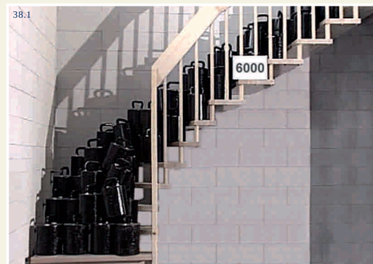
Erfolgreicher Belastungstest im Zuge der Typenstatik
