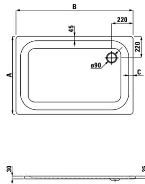
Stahlduschwanne, 65 mm extraflach, Stahl-Email 3,5 mm
