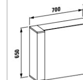
Spiegelschrank, mit 1 Beleuchtungselement, 230V/14W, IP44, Türanschlag gegenüber der Beleuchtungsseite
