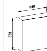
Spiegelschrank, mit 1 Beleuchtungselement, 230V/14W, IP44, Türanschlag auf Beleuchtungsseite
